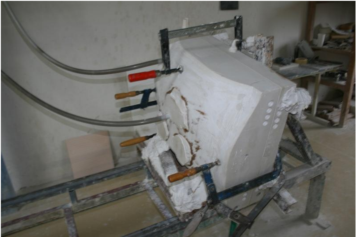
Obr. 41 forma na nalévací lavici [foto vlastní]
