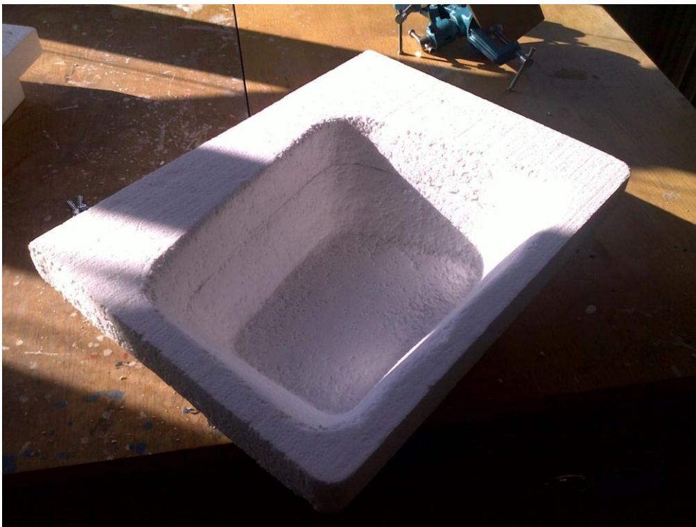
Obr. 9 polystyrenový model s mísou [foto vlastní]
