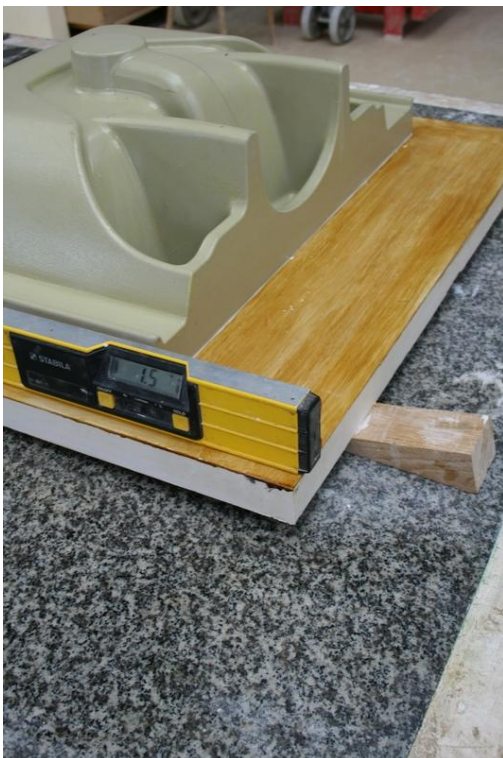
Obr. 28 vypodložená deska [foto vlastní]
