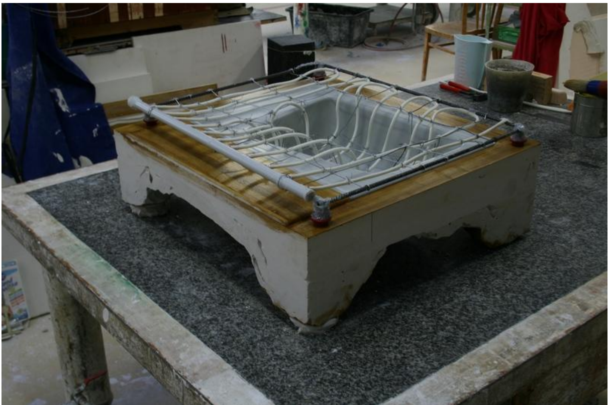
Obr. 32 příprava na první díl formy [foto vlastní]
