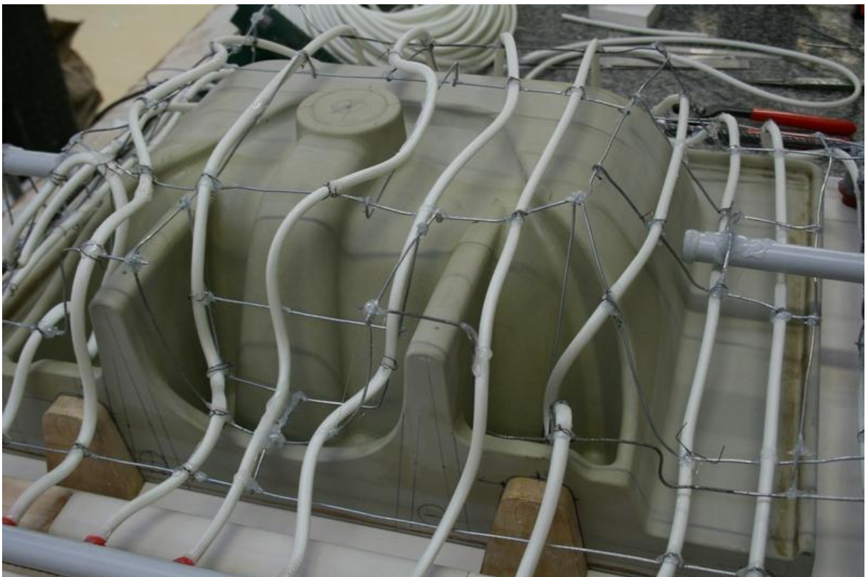
Obr. 38 příprava na druhý díl formy - trubky na jeřáb [foto vlastní]
