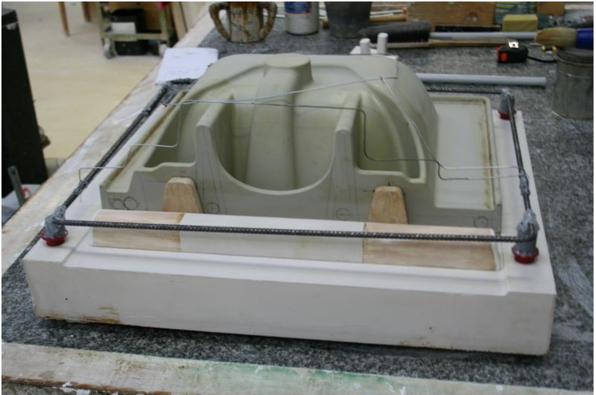
Obr. 37 klíny pro štople plus model kanálu [foto vlastní]
