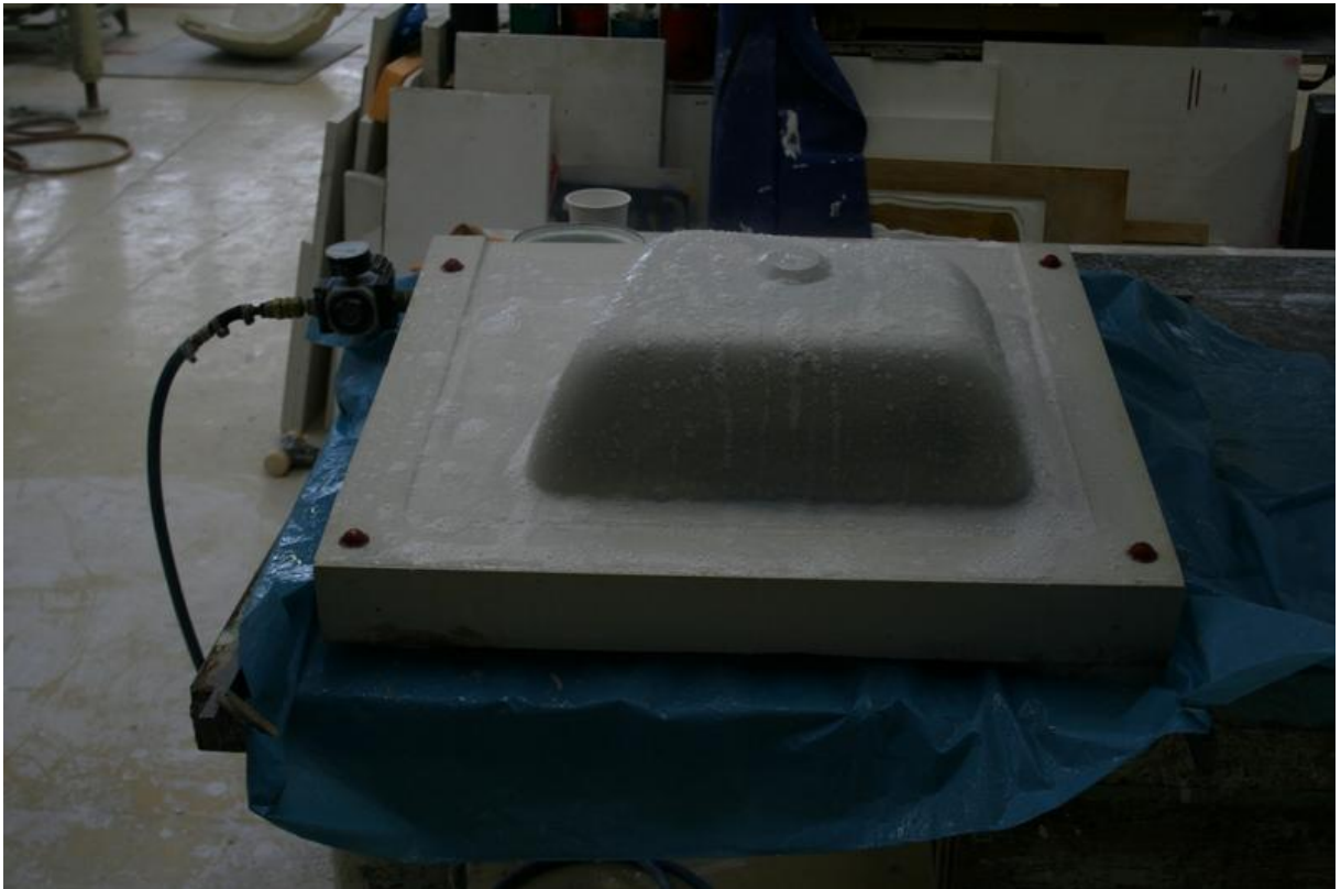
Obr. 39 vytlačení přebytečné vody [foto vlastní]
