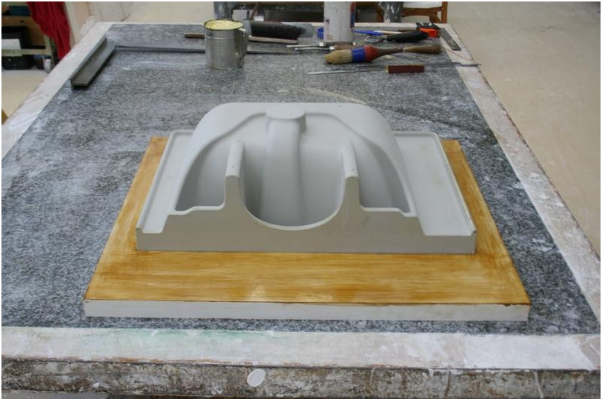
Obr. 27 model zasazený do desky [foto vlastní]
