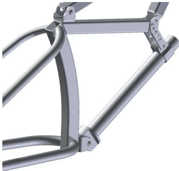
Obr. 31: Nastavení úhlu hlavového složení
