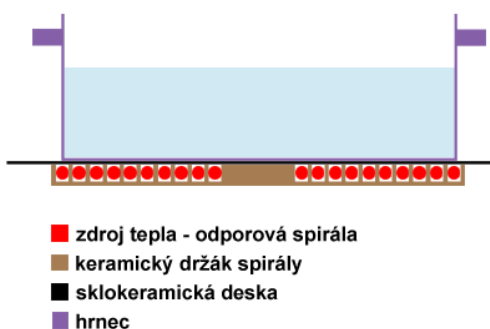
Obr. 2.4 Nákres sklokeramické varné zóny (převzato z [11])
