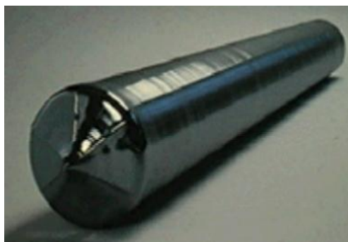
Obr. 6: Křemíkový ingot převzato [9]
