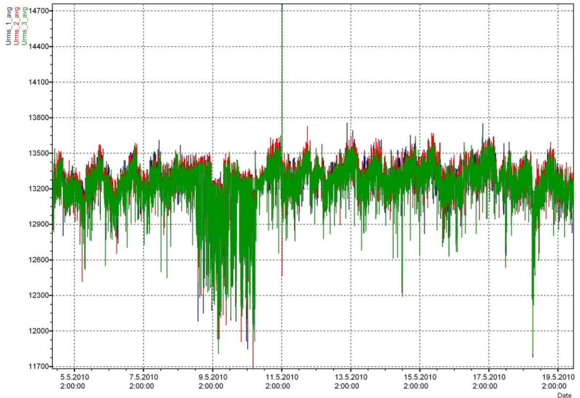
Obr. 3.1 Průběh fázových napětí za celé sledované období v síti 22 kV
