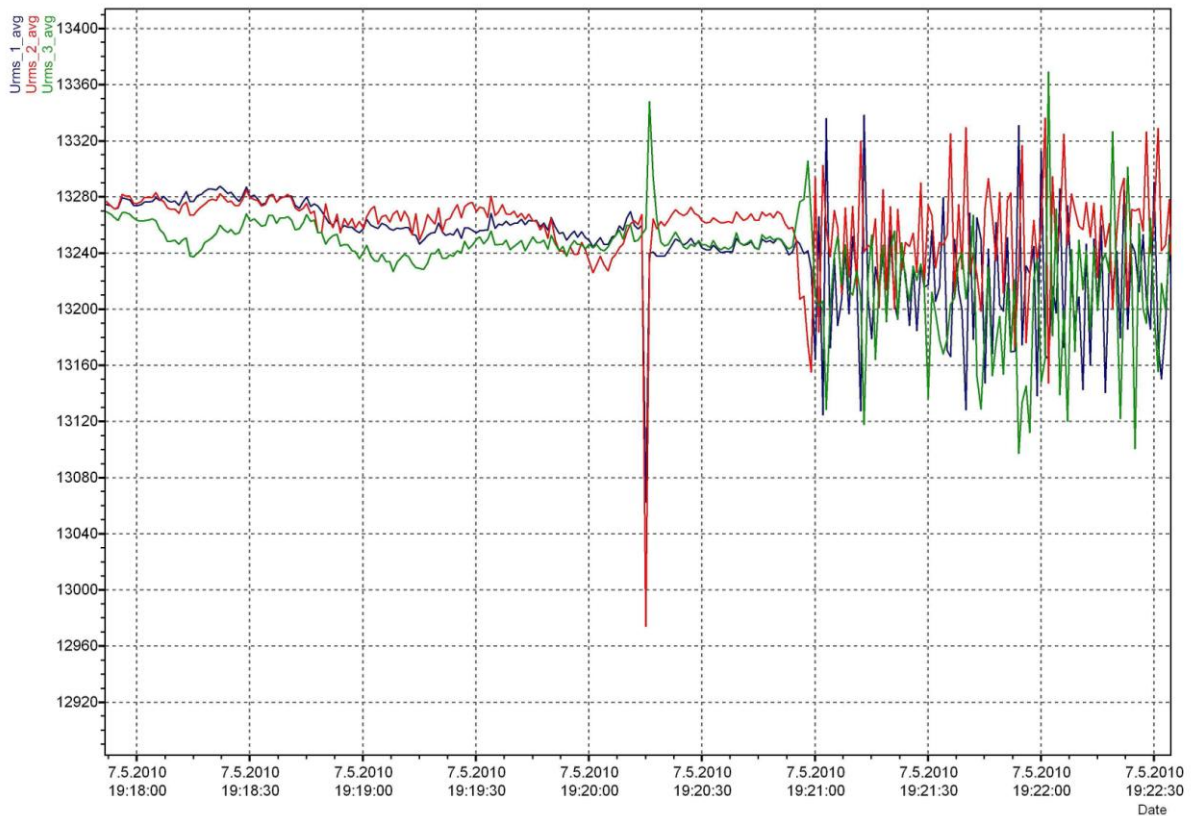
Obr. 3.2 Detail časového průběhu průměrných hodnot změn fázových napětí za 4 sekundy při výrazném poklesu napětí
