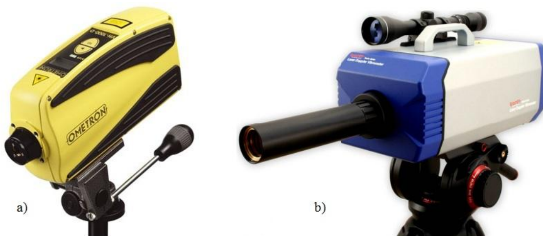
Obr. 4.9 Laserový vibrometr a) B&K 8337, b) OptoMET. Převzato z [16][28]
