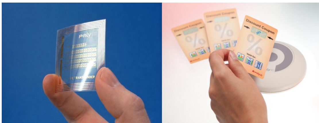
Obr. 3.2 Vlevo model RFID značky z řady PolyID a vpravo PolyLogo®-RAD [52]
