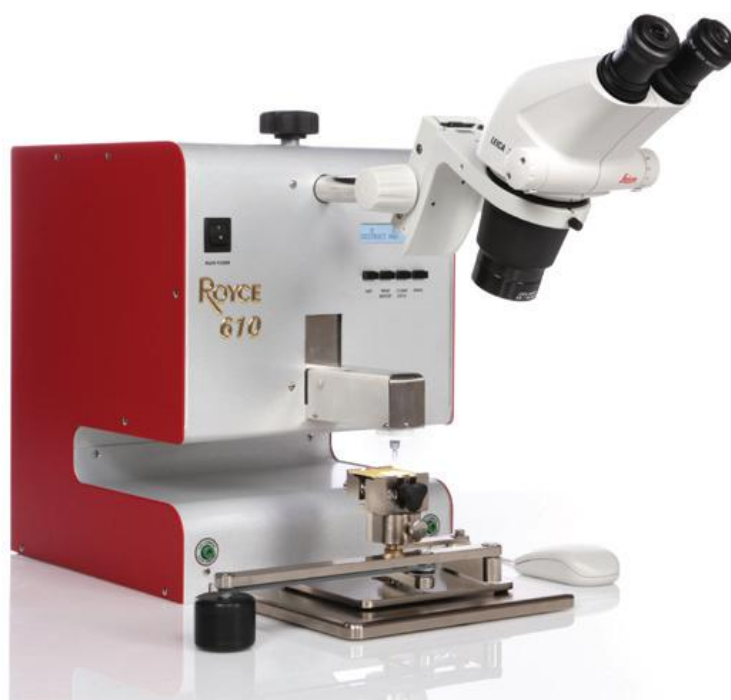
Obr. 3.4 Tester Royce 610 (převzato z [18])
