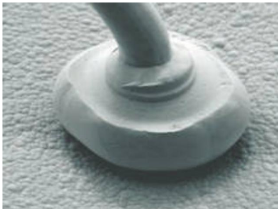
Obr. 1.6 Bond vytvořený kapilárou (převzato z [3])
