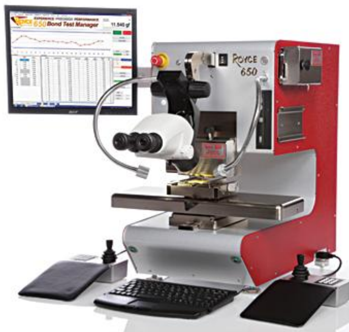
Obr. 3.6 Univerzální tester Royce 650 (převzato z [18])
