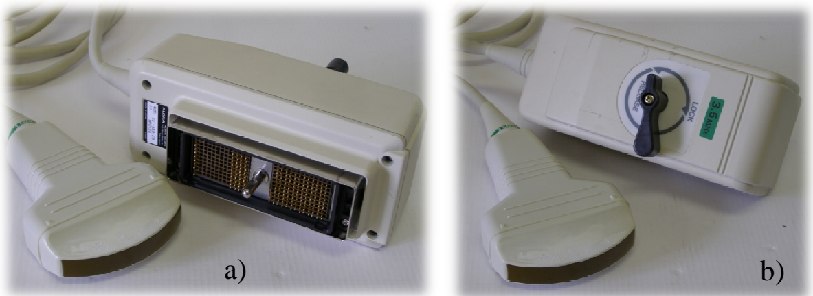
Obr. 39: Konvexní sonda s elektronicky buzenou řadou měničů, 3,5 MHz [112] a) sonda s portem natočeným stranou s kontakty (piny), b) sonda s portem natočeným stranou s páčkou mechanického fixačního zámku
