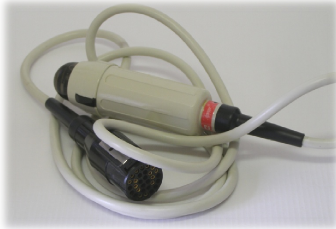
Obr. 36: Mechanická sektorová sonda (oscilační), 2,75 MHz [112]
