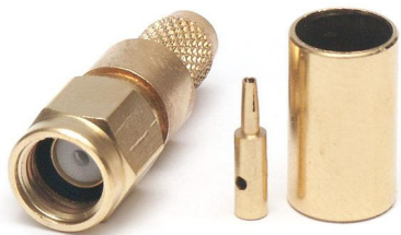
Obr. 1.6 VF konektor RSMA [19]
