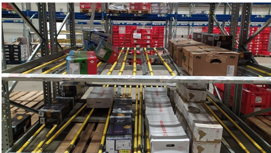
Obr. 27: Regálový systém s válečkovými dopravníky
