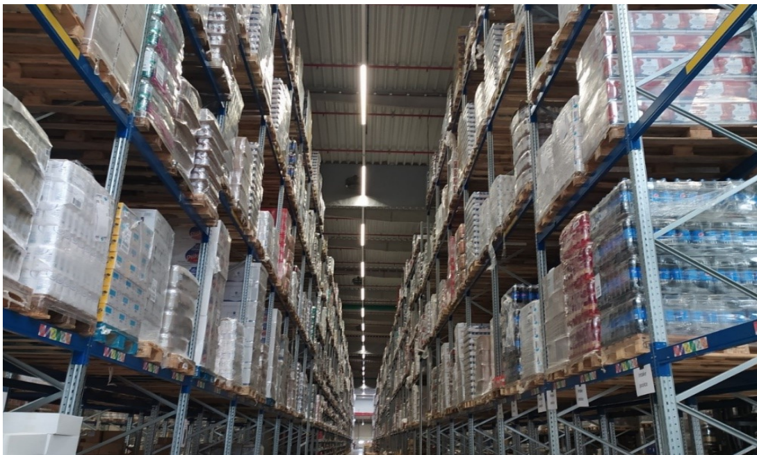
Obr. 22: Regálový skladový systém distribučního centra
