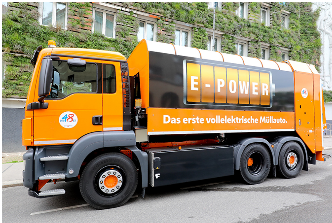
Obr. 4.5: Elektrické nákladní vozidlo pro svoz odpadu MAN [42]
