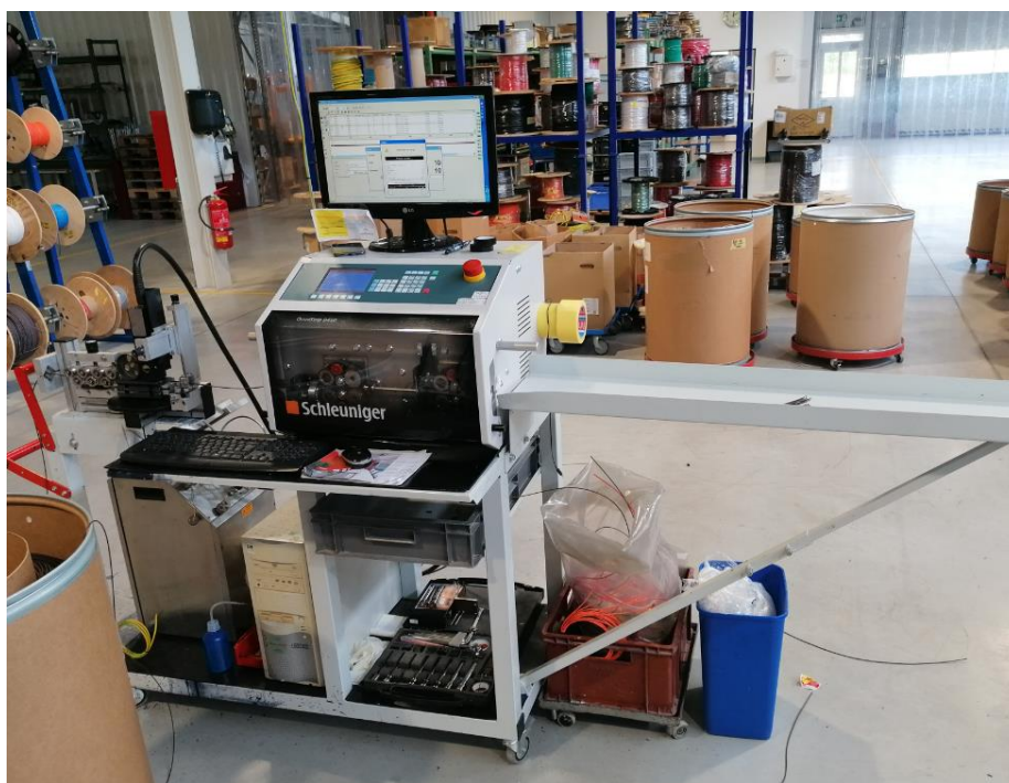
Obr. č. 17: Stříhací zařízení Schleuniger (foto autor)
