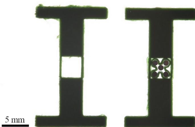
Obrázek 18: Vlevo: nástavec vyrobený FFF technologií 3D tisku, vpravo: stejný nástavec se vsazeným robotem výchozí verze.
