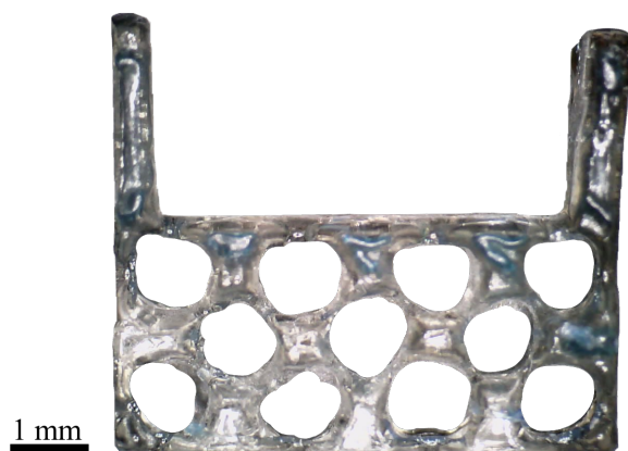
Obrázek 17: Tělo robota zhotovené pomocí velkoplošného laserového plotru.
