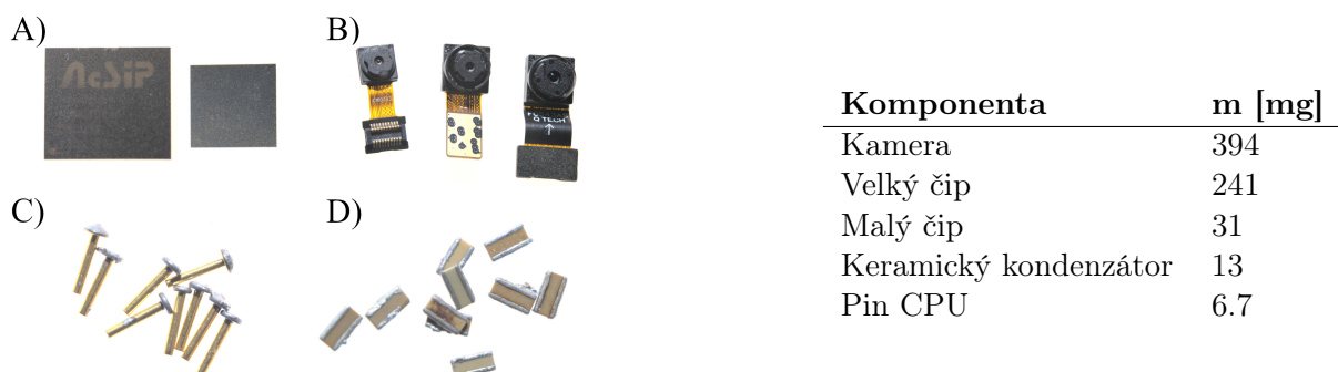
Obrázek 12: Na obrázcích vlevo: vzorky komponent pro separaci. A) čipy, B) kamery, C) piny, D) kondenzátory. Jednotlivé snímky komponent nejsou v odpovídajícím měřítku. V tabulce vpravo: zjištěná průměrná hmotnost jednotlivých komponent.
