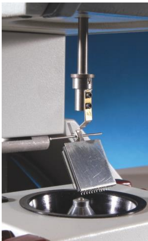
Obr. 8: Ukázka metody smáčecích vah – ponoření do kuličky pájky. Převzato z [2].
