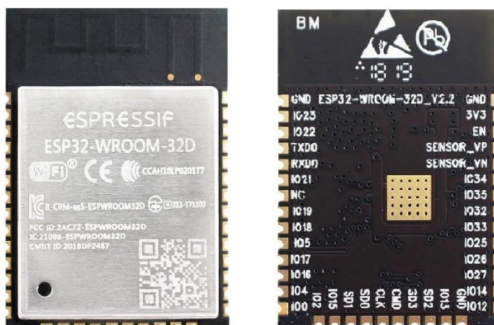
Obr. 7: Modul mikroprocesoru ESP32-WROOM-32D. Převzato z [26]
