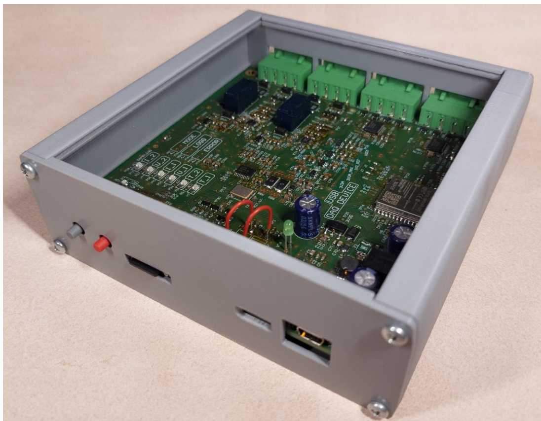
Obr. 44: Pohled na přední stranu měřicí karty a ovládací prvky
