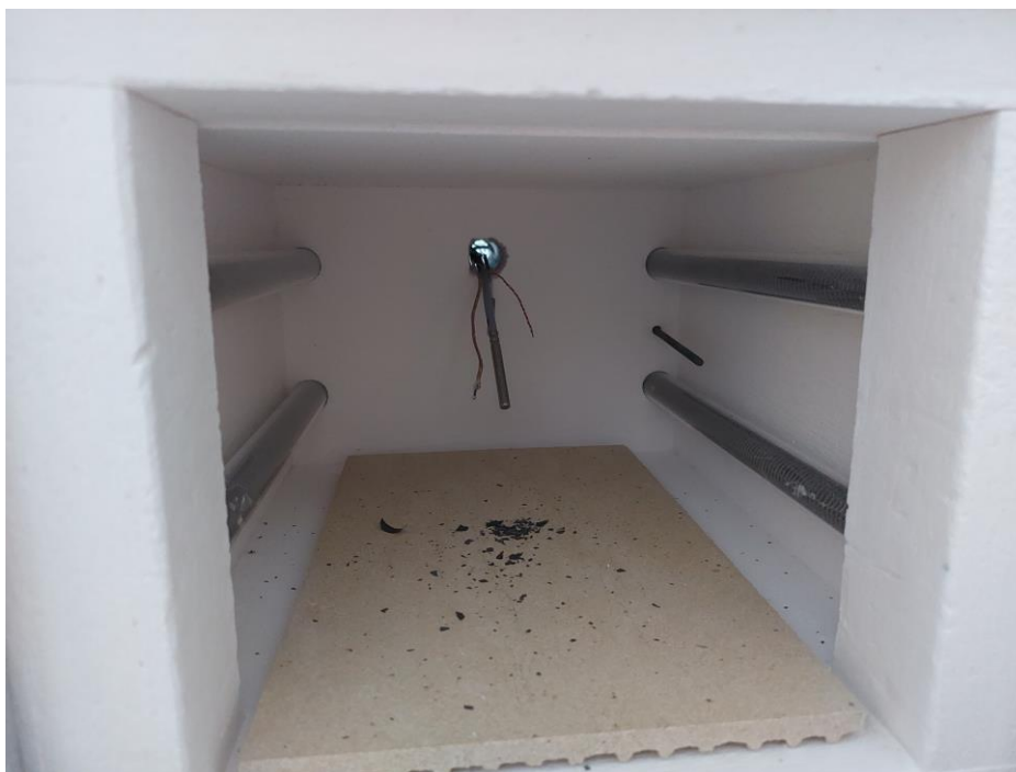
Obr. 41: Pohled do pece s vloženými teplotními senzory
