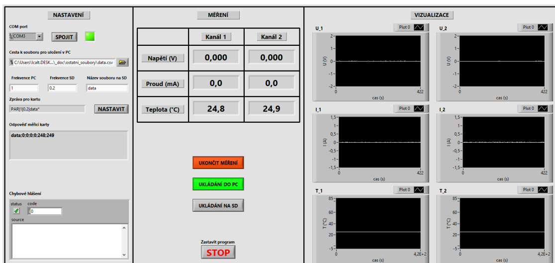
Obr. 34: Grafické uživatelské rozhraní – program spuštěn, připojena měřicí karta, nastaveny požadované parametry a spuštěno měření i ukládání do souboru v PC
