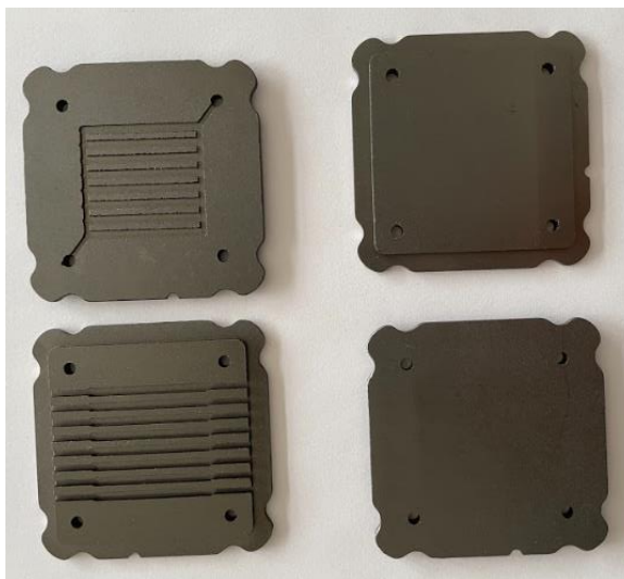
Obr. 40: Grafitové bipolární desky s rozvodnými kanálky.
