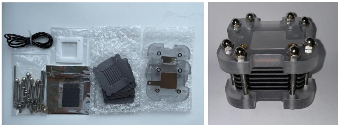
Obr. 23: Jednotlivé komponenty pro složení pětičlánekového stacku (vlevo) a výsledný složený stack (vpravo).
