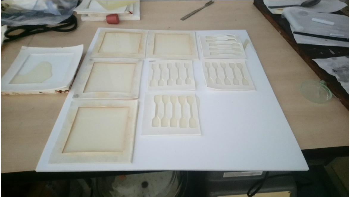
Obr. 3.1.1 Fotografie vzorků epoxidových pryskyřic při vytvrzování
