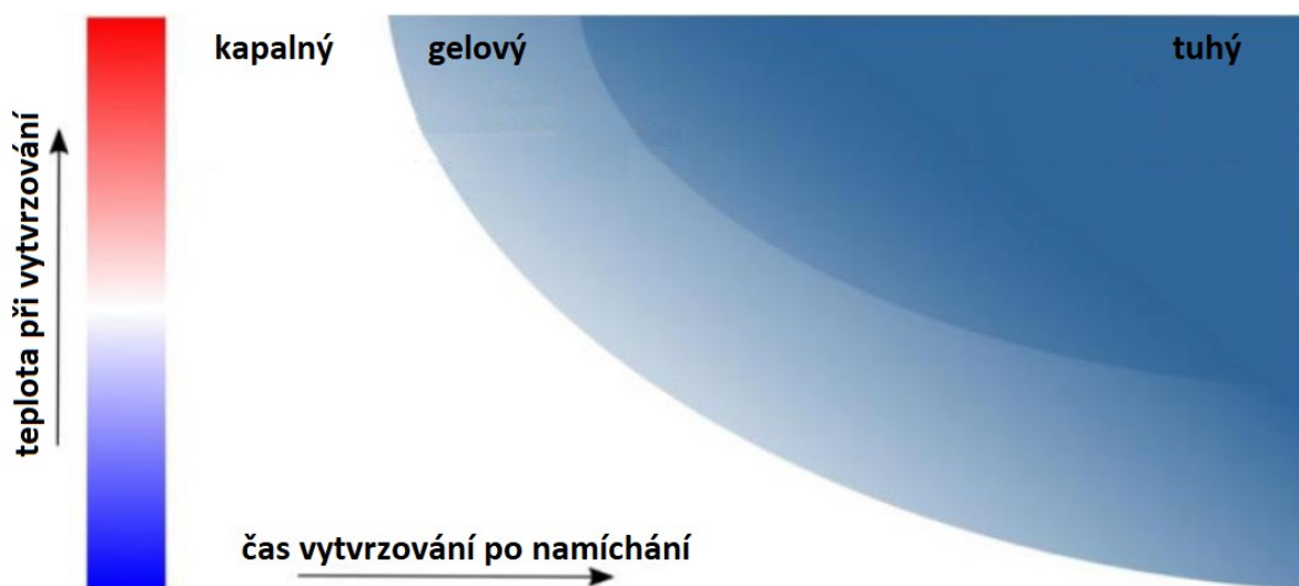
Obr. 1.3.1 Vliv okolní teploty na dobu vytvrzování a na stav epoxidové pryskyřice (inspirováno [22])
