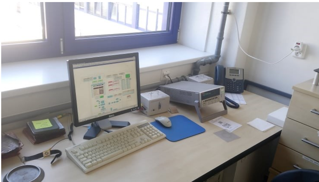
Obr. 3.2.1 Fotografie tříelektrodového měřicího systému spojený do KEITHLEY 6517A a řízen počítačem
