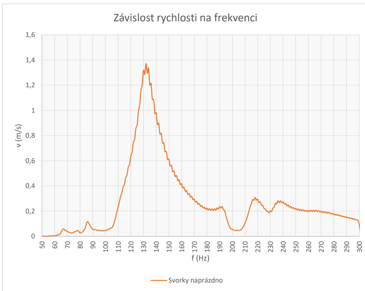
Graf 3: Výchozí stav vibrací kmitajícího panelu (bez působení ladícího systému) v závislosti na frekvenci
