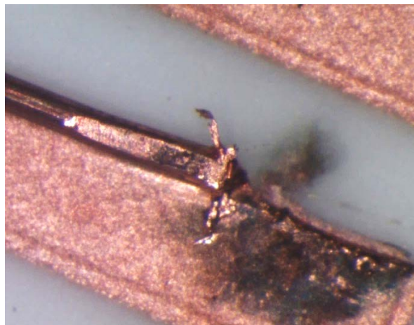
Obrázek 33: Špatně navařený drátek 220 μm.
