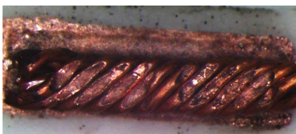
Obrázek 35: Správný kontakt 440 μm odporovou metodou.
