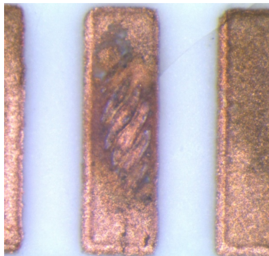
Obrázek 26: Odtrh lanka krytého adhezivem RESBOND™ 989 z kontaktní plochy.
