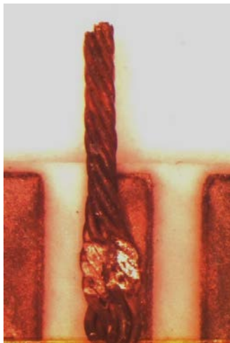
Obrázek 28: Přetržené lanko 440 \mu\text{m} po mechanické zkoušce a testech v teplotní komoře.
