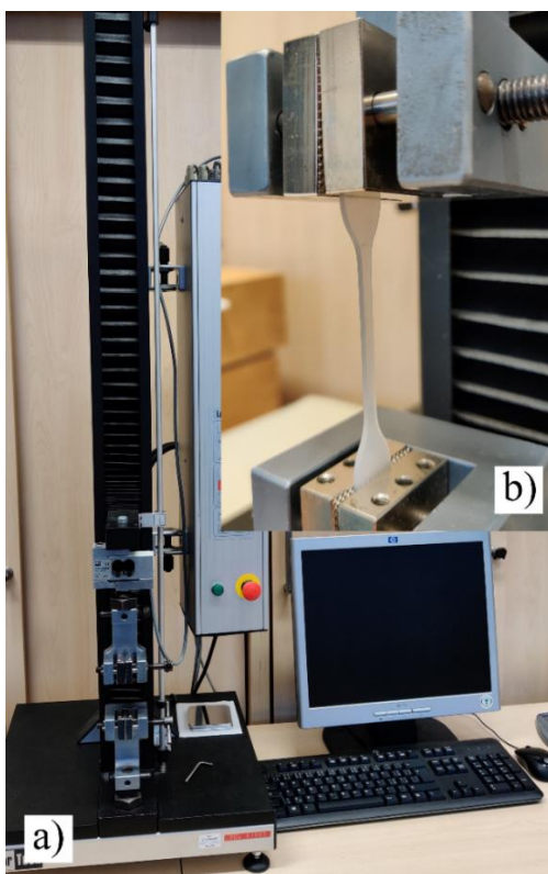
Obr. 14: Zkušebním stroji LabTest: a) pohled na přístroj, b) upevnění vzorků v čelistích.
