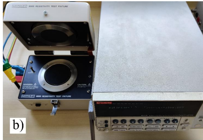
Obr. 7: Použité laboratorní přístroje k měření rezistivity: a) schématické zobrazení, b) pohled na měřící přípravek a elektrometr.
