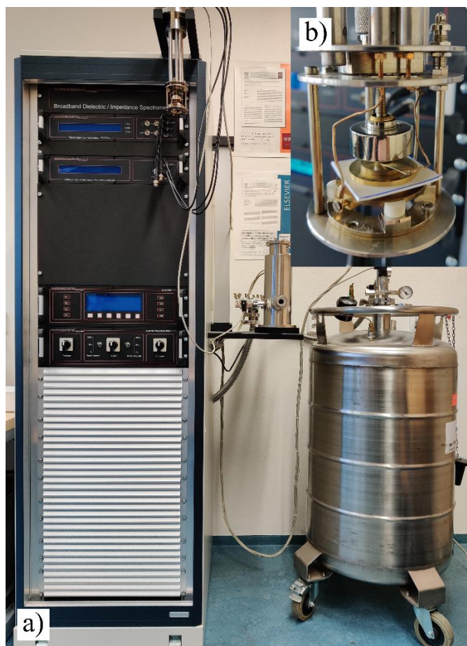
Obr. 9: Měřicí aparatura širokopásmové dielektrické spektroskopie: a) pohled na přístroj včetně kryostatu, b) pohled na dvuelektrodivý systém s upevněným vzorkem.
