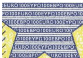
Obrázek 18: Mikrotisk z přední části eurobankovky 100 €
