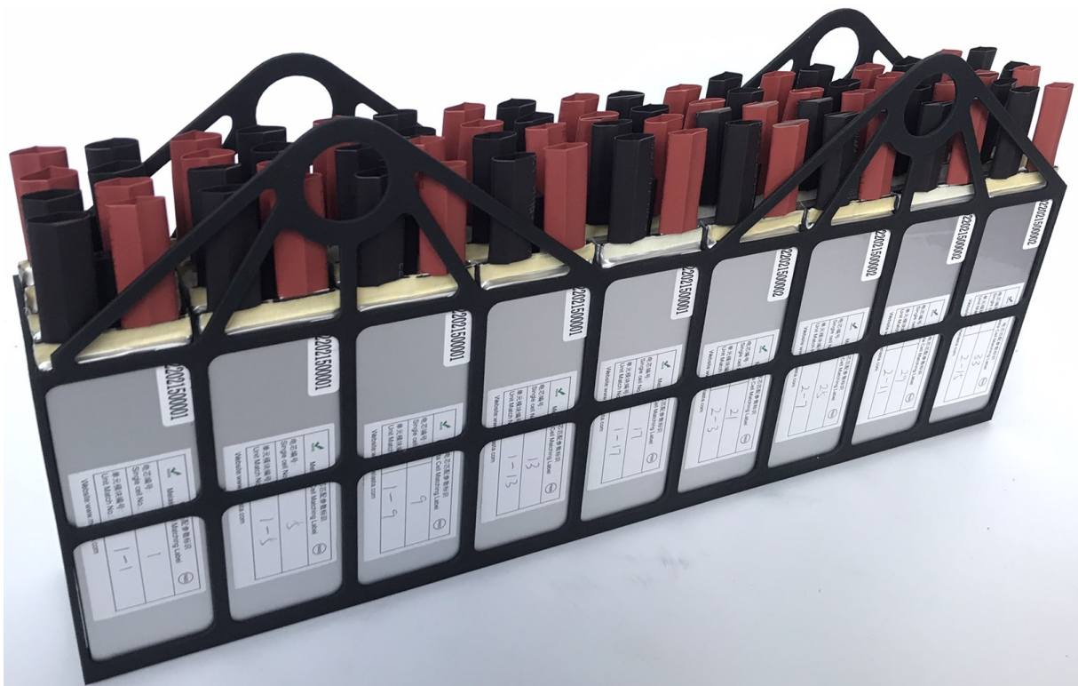
Obrázek 54: Segmentový koš obsahující všech 36 článků
