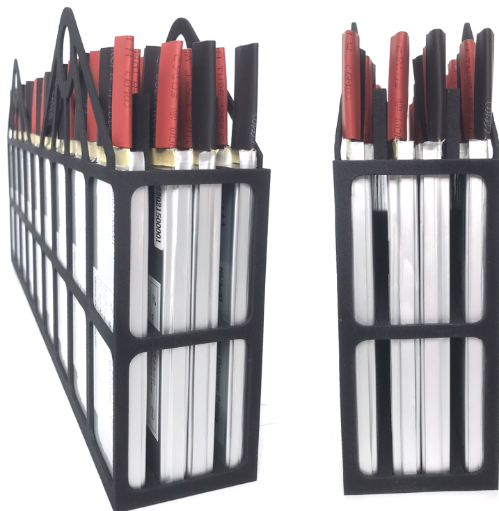
Obrázek 55: Segmentový koš obsahující všech 36 článků - znázornění 5mm mezery pro chlazení
