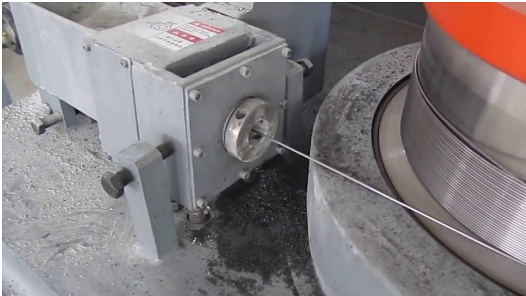
Obr. 2: Blok drátotažné linky (9)
