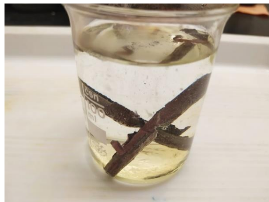
Obr. 22: Vodíkování v 17 % roztoku HCl
