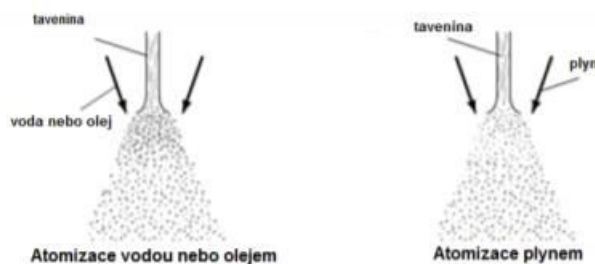
Obr. 2 Atomizace vodou a plynem [1]
