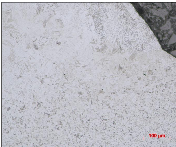
Obrázek 35: Hranice ztavení svařový kov a SCGA980, x200
