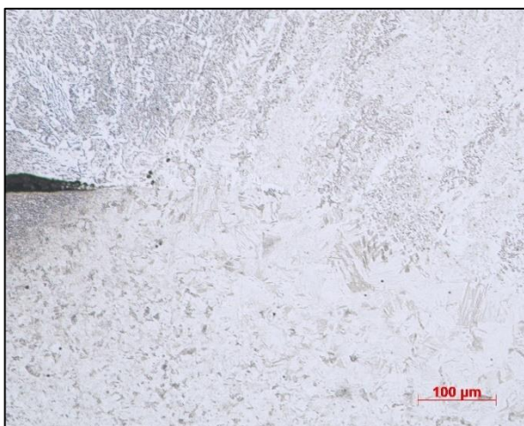
Obrázek 37: Kořen svařového kovu, x200
