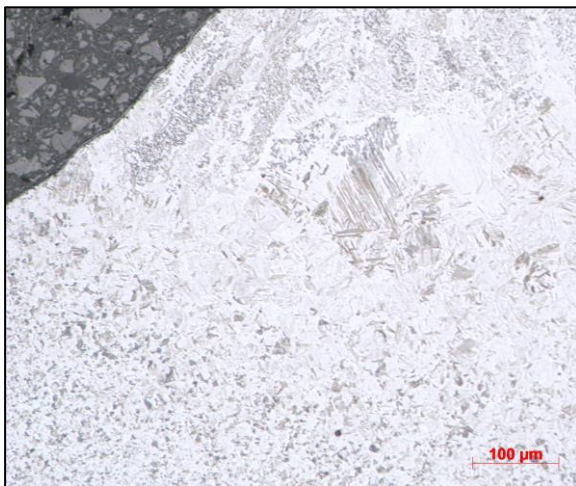
Obrázek 40: Hranice ztavení svarový kov a SCGA980, x200
