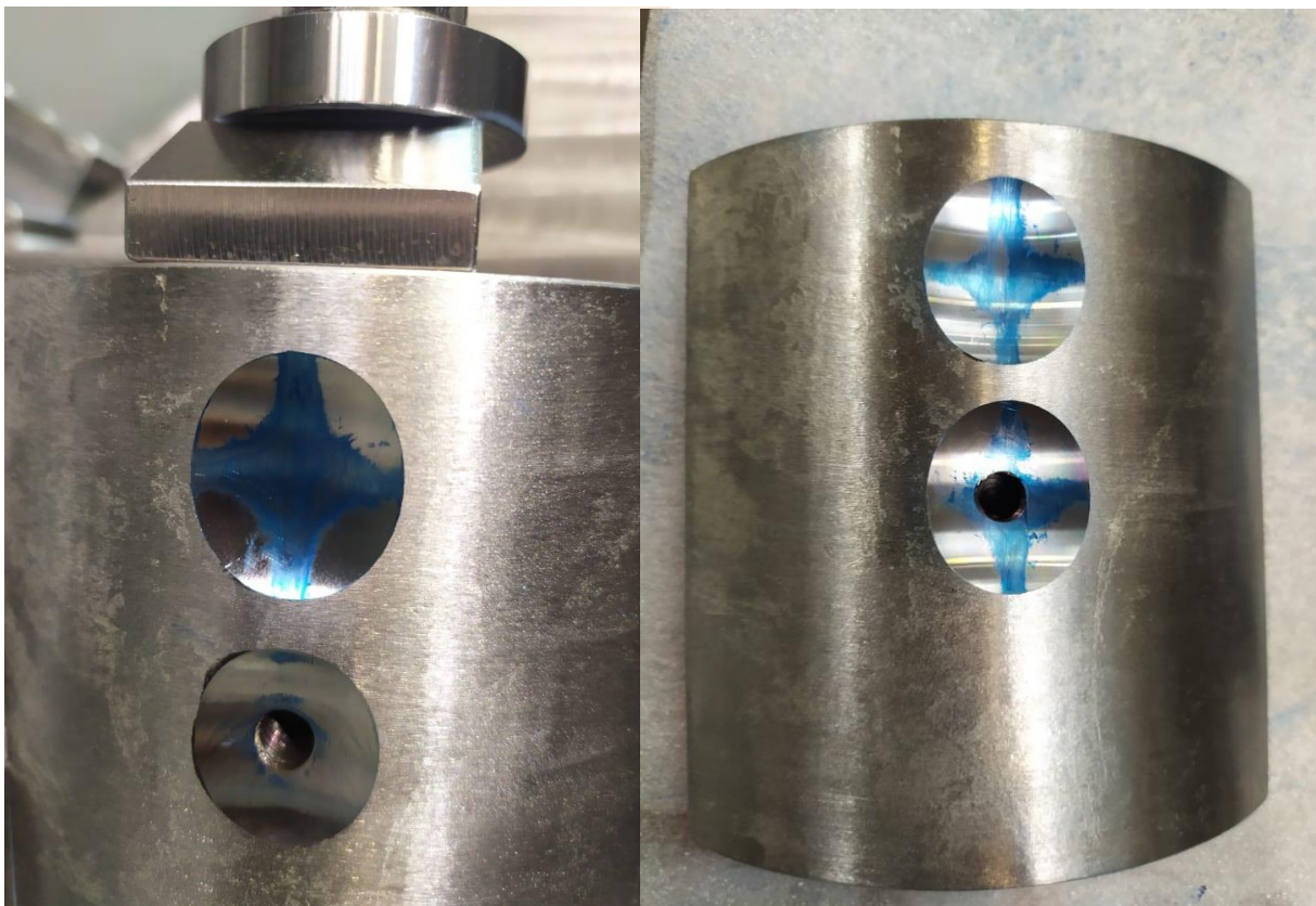
Obr. 22: Otisk po špindlování
