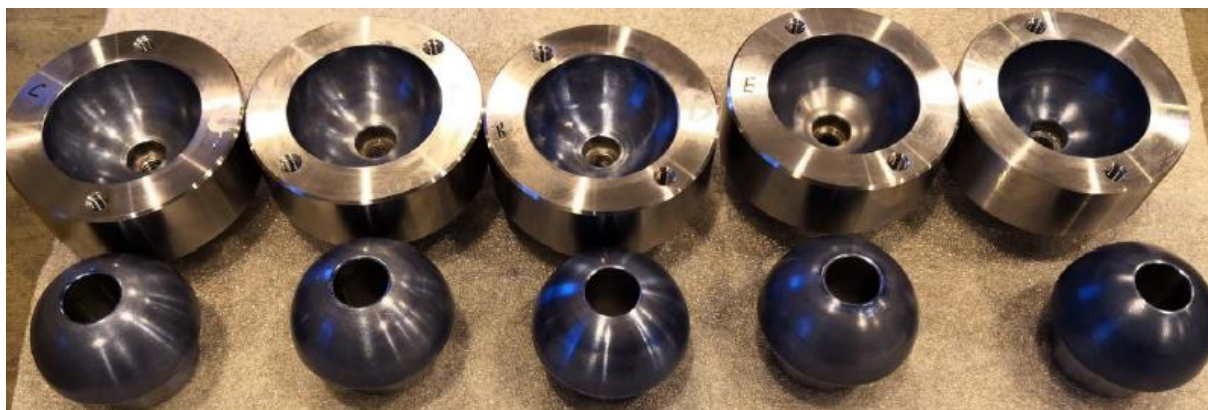
Obr. 25: Výsledný otisk barvy po dokončení zabíhání [14][15][16]
