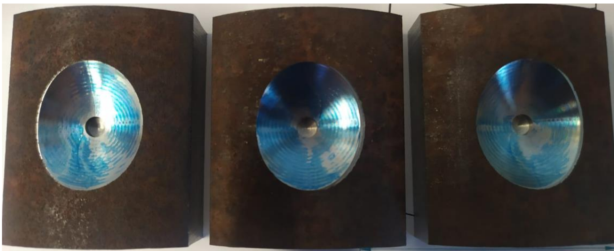
Obr. 32: Otisk po zkoušce barvou socket varianta 2
