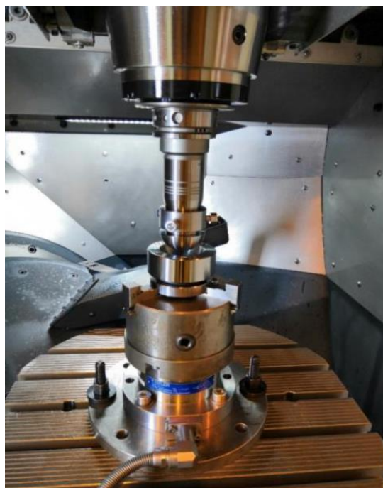
Obr. 24: Sestavený mechanismus, připravený k zabíhání [14] [15] [16]
