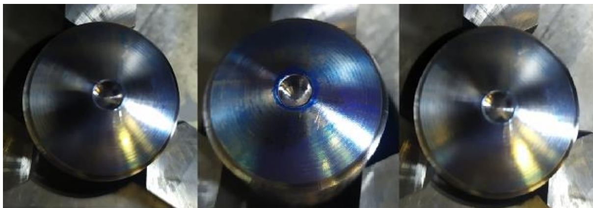
Obr. 34: Otisk po zkoušce barvou ball varianta 2
