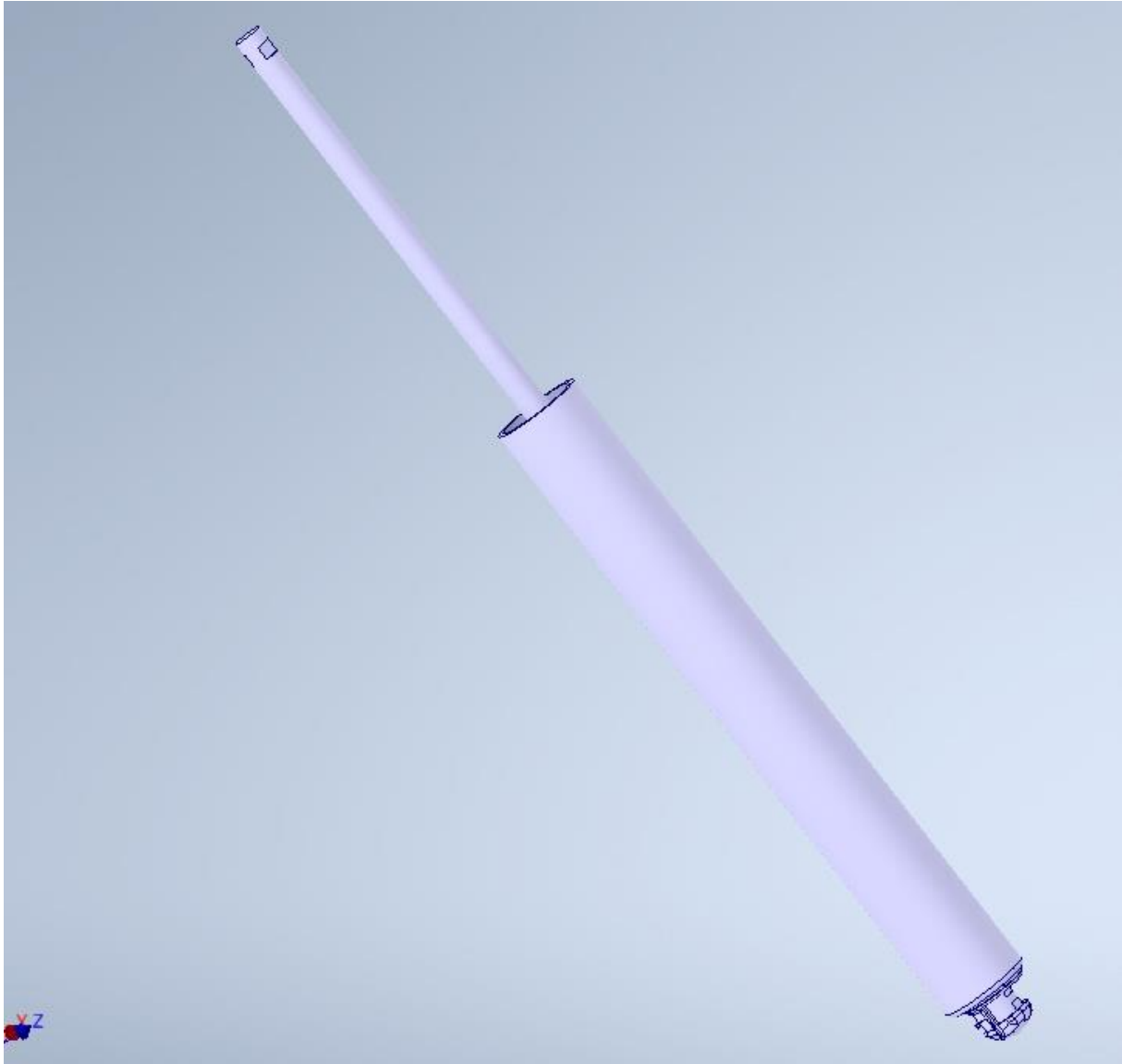
Obr. 41: Model simulující aktuátor pro FEM analýzu
