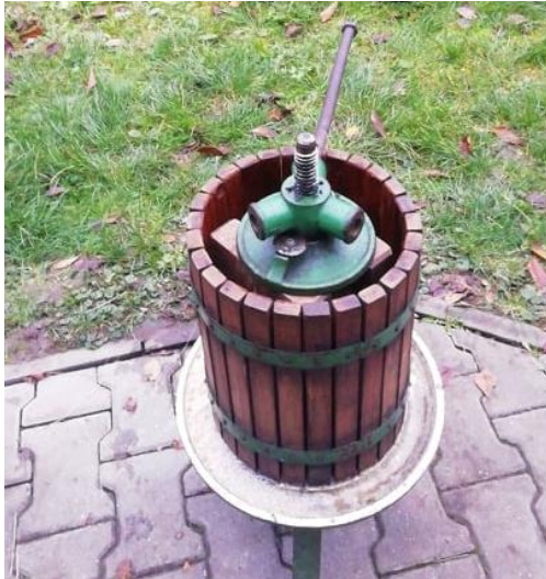
Obrázek 7 Ruční vřetenový lis na výrobu ovocné šťávy
