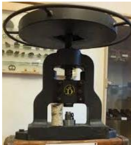
Obrázek 6 Vřetenový lis využívající kinetické energie disku [32]
