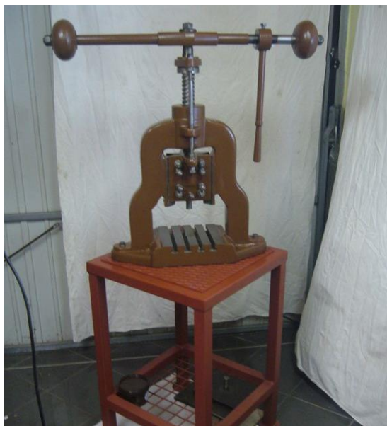
Obrázek 5 Vřetenový lis využívající kinetické energie závaží [29]
