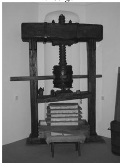
Obrázek 3 Dřevěný ruční vřetenový lis pro lisování naklíženého papíru [20]
