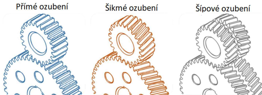
Obr. 10 – Druhy válcového ozubení [4]
