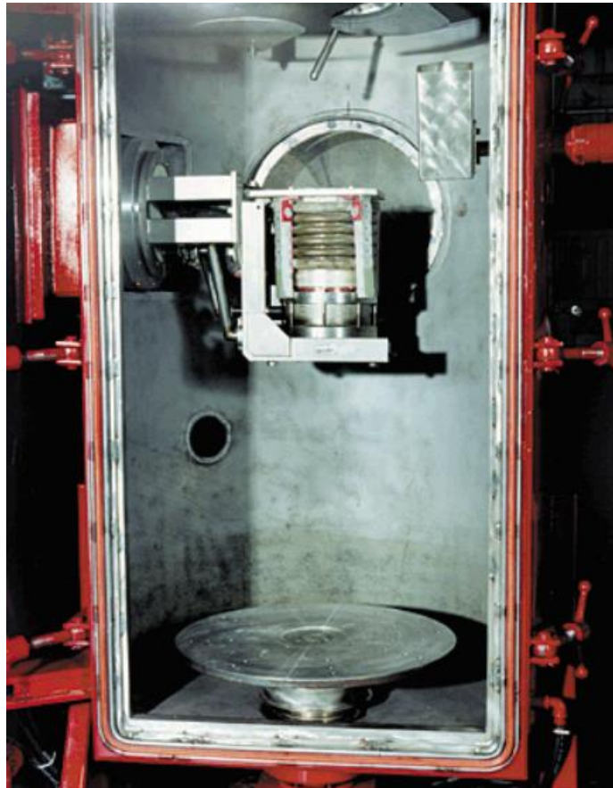
Obr 4.1 Studený kelímek, odlévání titanu odstředivě [10]
