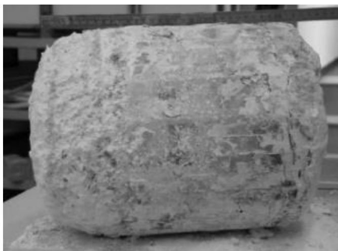
Obr 4.5 Výtavek ze studeného kelímku, krystal o délce 50 mm. [13]
