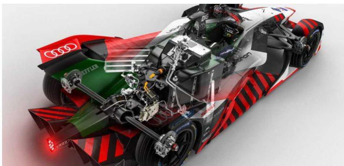
Obrázek 10: Umístění pohonného ústrojí ve FE zezadu (převzato z [31])
