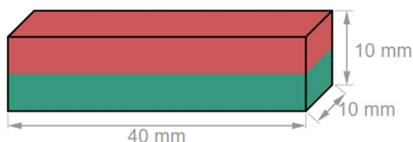
Obr. 4.29 Geometrie použitého permanentního magnetu – převzato [17]
