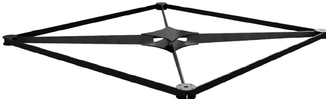
Obr. 14 Render rámu ve Fusionu před vyřezáním
