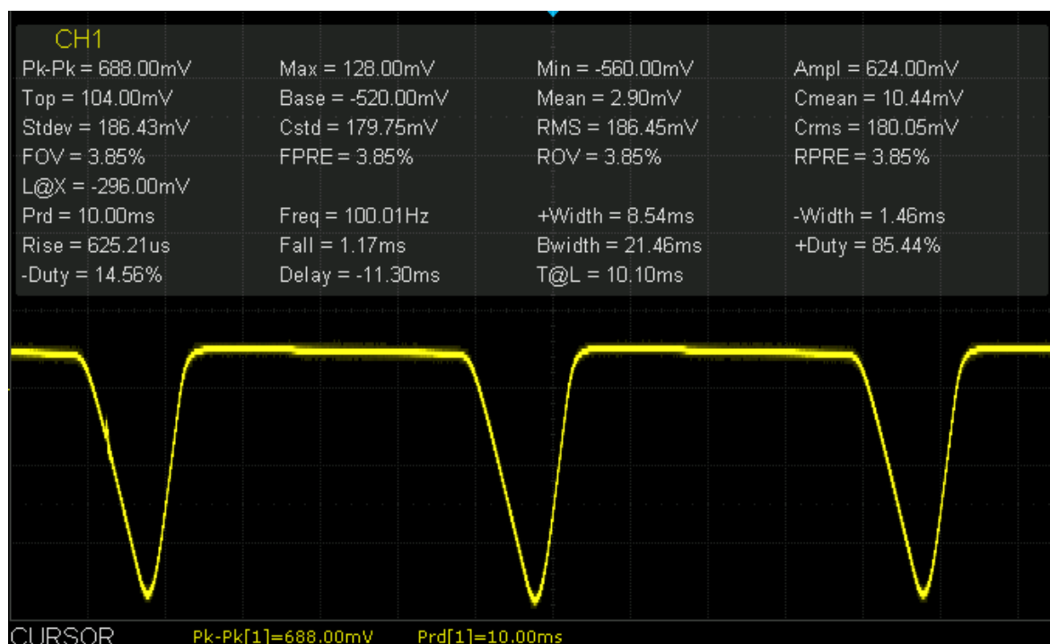
Obr. 4.5 Oscilogram s časovým průběhem výstupního napětí 5 V kanálu
