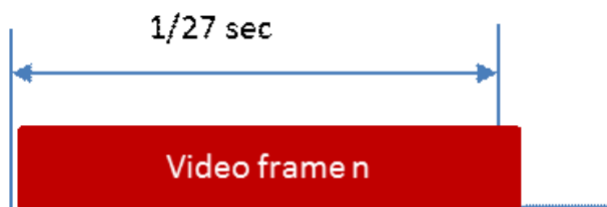
Obr. 2.5: Desynchronizace způsobena příliš pomalým čtením o nízké frekvenci clock signálu f_{CLK} [Převzato z [4]]
