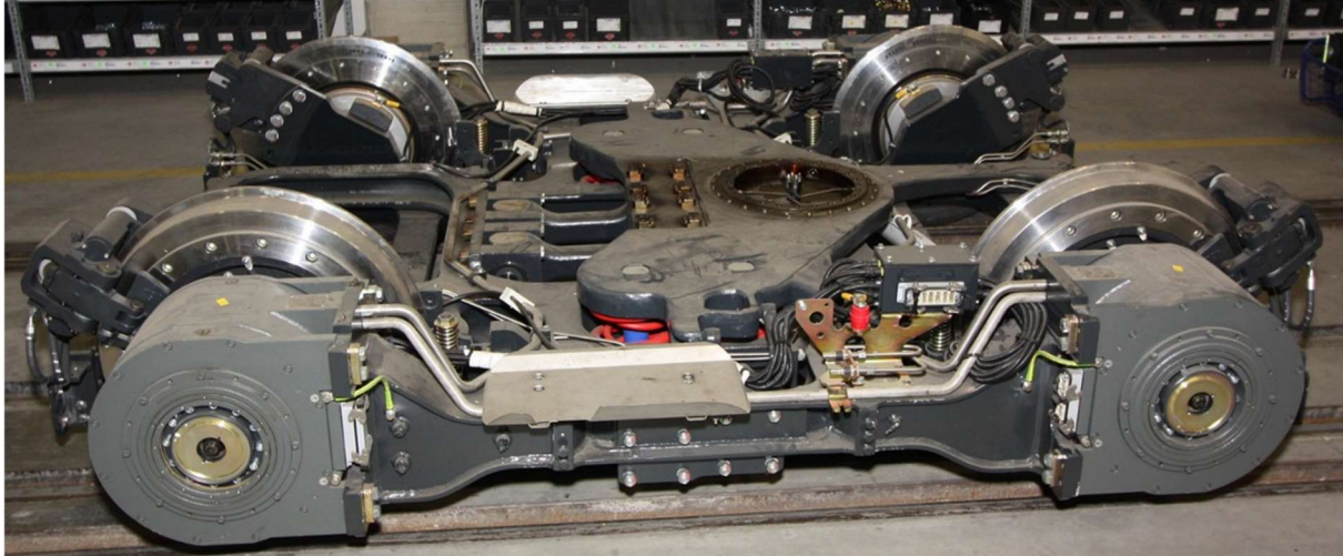
Obrázek 13 Podvozek tramvaje For City pro krajní článek [6]
