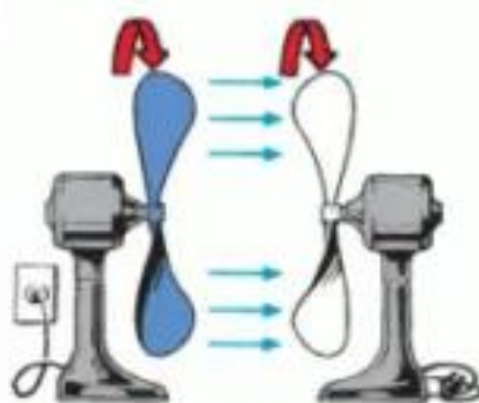
Obrázek 21 Princip hydrodynamické spojky [11]
