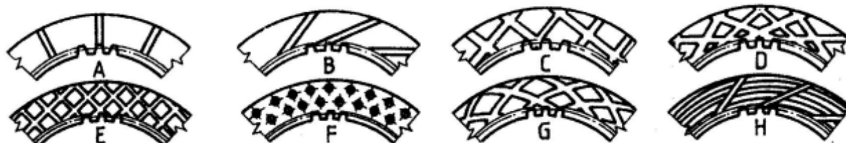
Obr. 7 Plošné drážkování spojkových lamel: A - radiální, B - tangenciální, C, E - křížové, D - dvojitě tangenciální, F - dírkované, G - dvojitě spirální, H - spirální s tangenciálním
