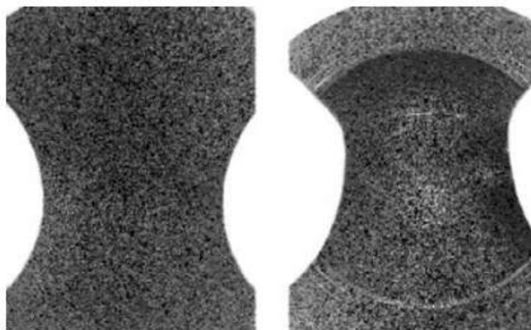
Obrázek 17: Náhodný (stochastický) nástřik vzorku před a po zkoušce [14]
