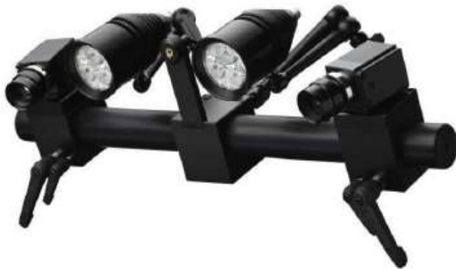
Obrázek 19: Soustava kamer a osvětlení systému ARAMIS [1]
