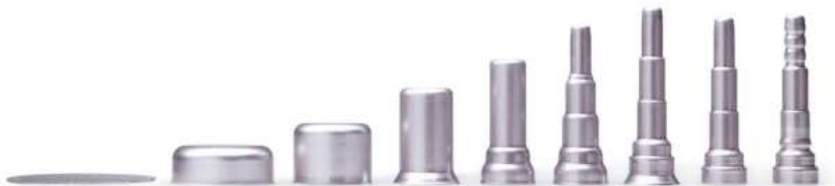
Obrázek 3: Výtažek vyrobený tažením se ztenčením stěny [10]
