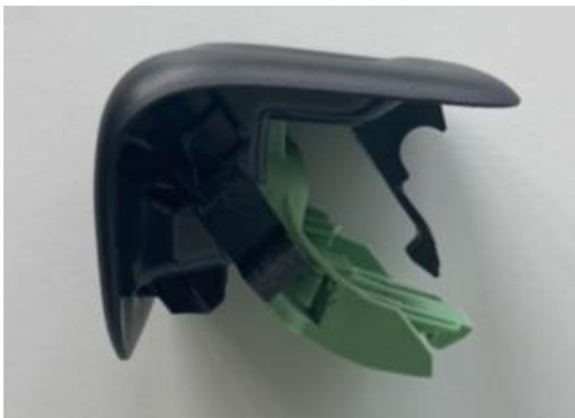
Obrázek 57 – zkouška kompatibility páky s originálním rámečkem – boční pohled
