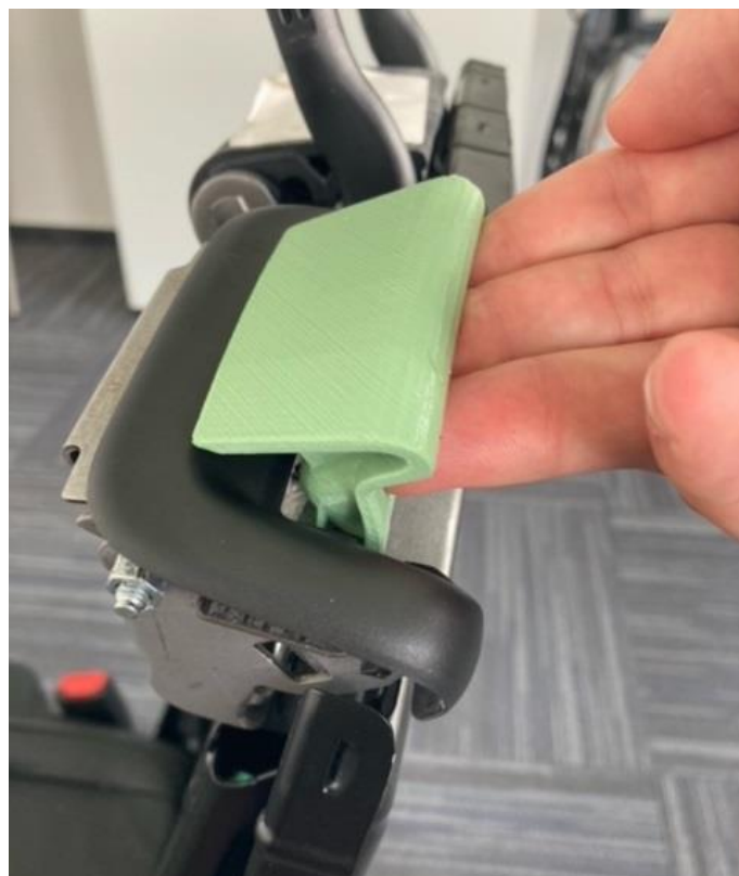
Obrázek 64 – zkouška funkčnosti a kompatibility s rámečkem
