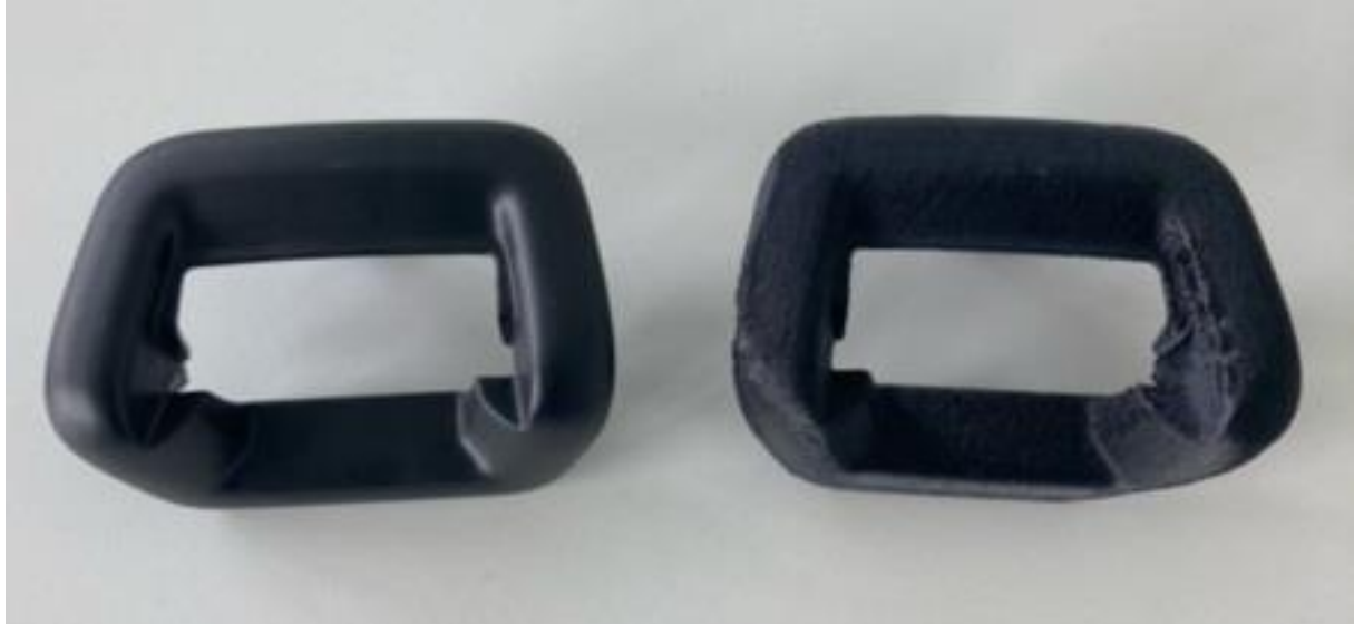
Obrázek 55 – porovnání vstříkovaného a 3D tištěného rámečku
