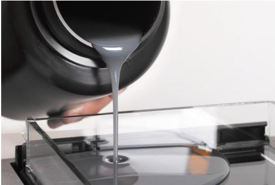
Obrázek 6 – ukázka plnění nádrže SLA tiskárny pryskyřicí (resin) [10]
