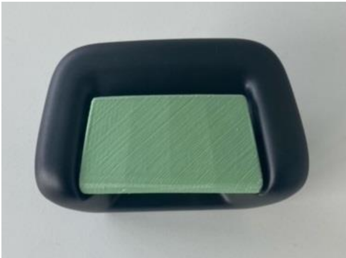
Obrázek 56 – zkouška kompatibility páky s originálním rámečkem – horní pohled
