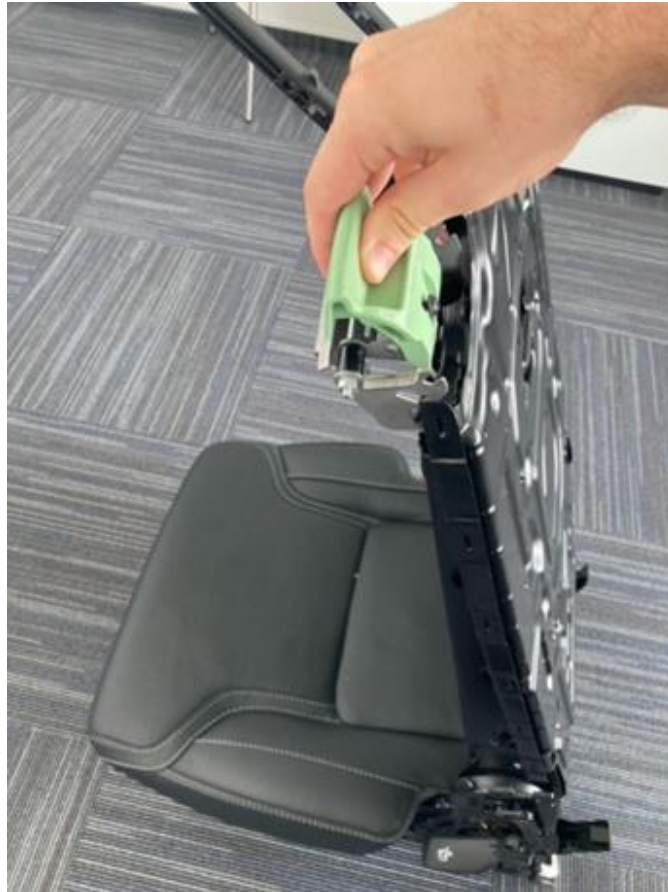
Obrázek 63 – funkční zkouška, sedadlo ve sklopené poloze
