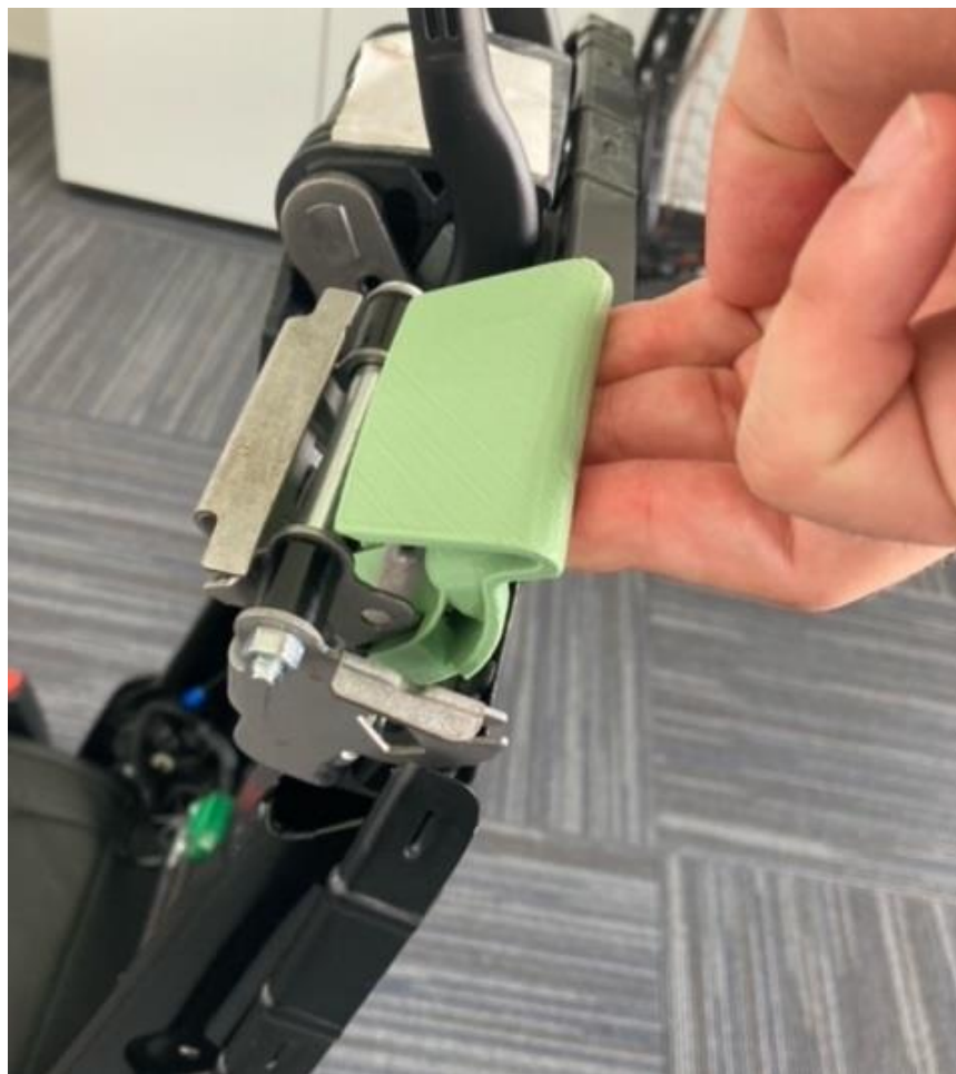
Obrázek 62 – funkční zkouška (rámeček pro názornost odstraněn)
