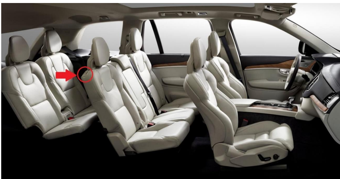
Obrázek 22 – interiér vozu Volvo XC 90 T6 s vyznačeným mechanismem easy entry [38]
