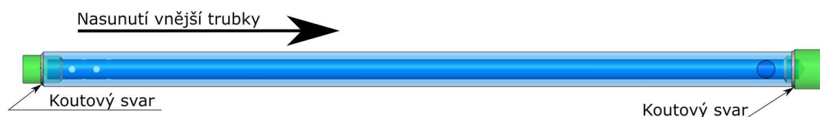
Obrázek 92. Ustavení vnější trubky a svaření
