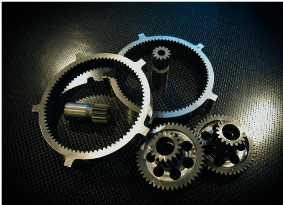
Obrázek 5: Elbflorace – ozubení planetové převodovky (9)
