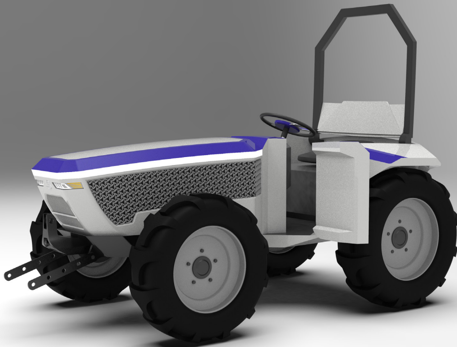
render - odklopené víko, shrnuté lamely, otevřené dveře, připraveno pro řízení řidičem
