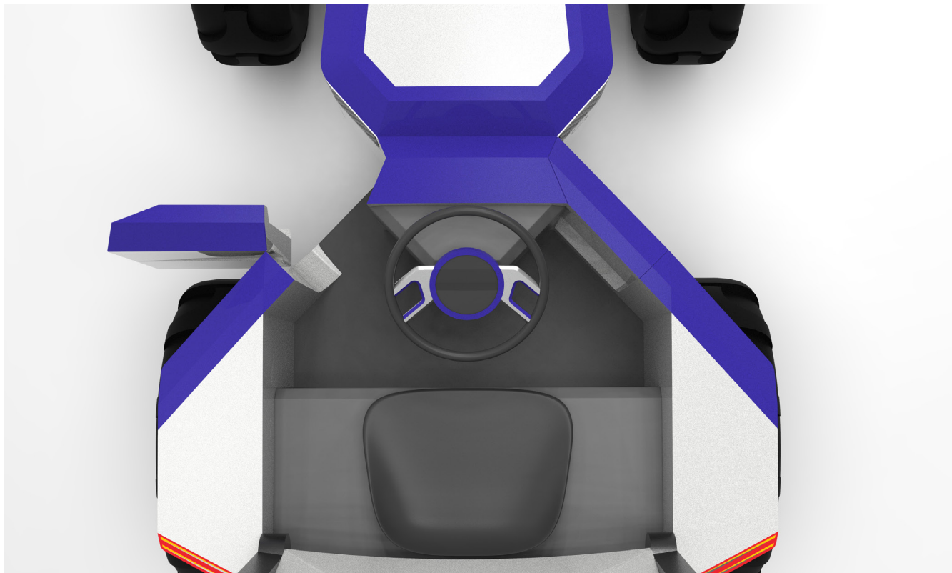
render - detail vnitřního prostoru a volantu s dotykovým displejem uprostřed, sedačka, pod sedačkou úložné prostory
