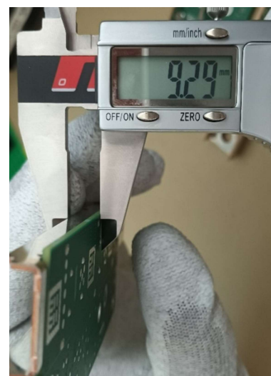
Obr. 5-4 Změřený průhyb mimo toleranci [zdroj - vlastní]
