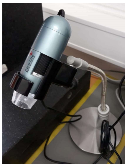
Obr. 4-4 Dino - lite digitální mikroskop [24]
