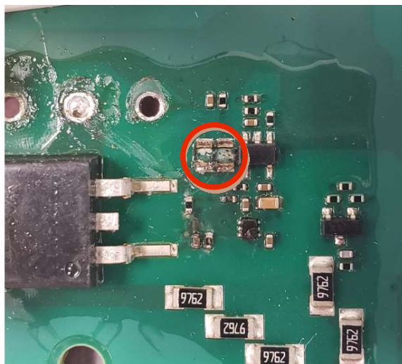
Obr. 5-6 Chybějící komponenty u výroby 644 F [26]
