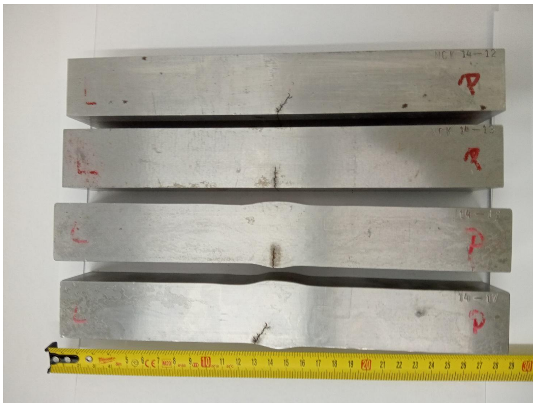
Obr. 19 Tělesa opatřena umělou vadou vytvořenou za pomoci drátořezu.
