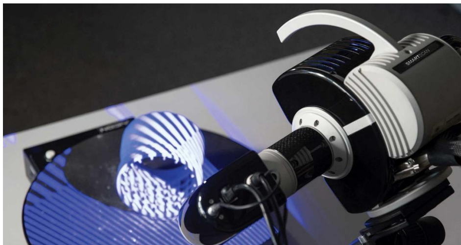
Obr. 13: Příklad skeneru se strukturovaným světlem [13]
