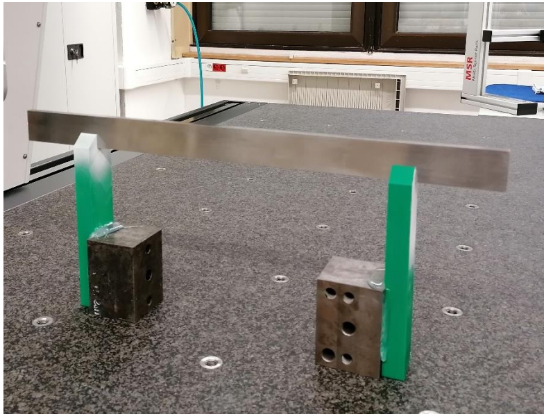
Obr. 30: Upnutí základní měrky délky 500 mm ve směru osy X
