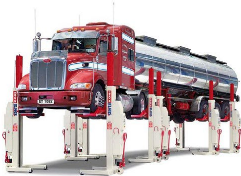
Obrázek 12: Mobilní sloupové zvedáky, sestava 10 sloupů [22]
