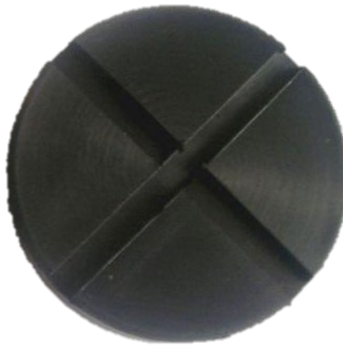
Obrázek 22: Ustavovací deska – gumová podložka s vybráním pro práh automobilu [28]
