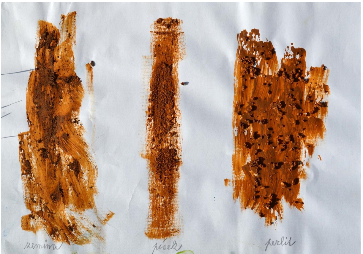
Příloha 6 - zkouška struktur - zemina, písek, perlit s akrylovou barvou
