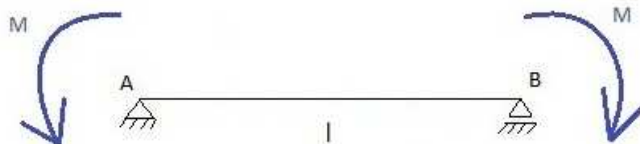
Obr. 5.5: Prostý nosník zatížený momentem M v podporách
