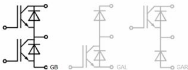
Obrázek 51: Topologie pro realizaci pulsního měniče
